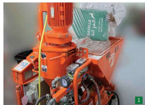
Chargement du MPE 80 dans la machine
